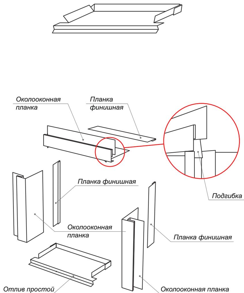
Для крепления откоса Околооконной планки вплотную к раме окна с боков и сверху установите Планку финишную 46x25. Околооконные планки стыкуйте между собой, как показано на схеме.
