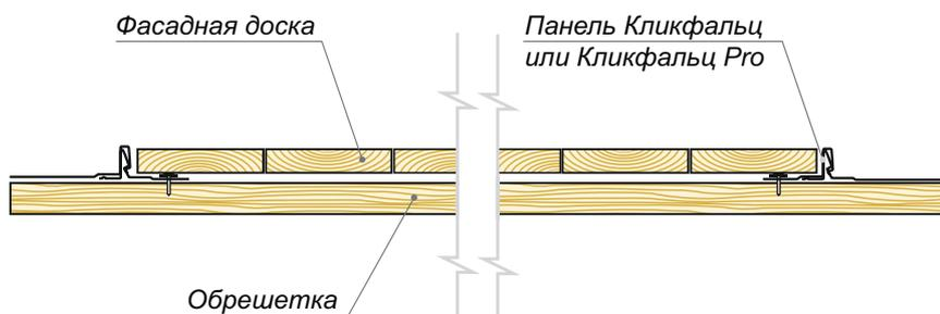
Если часть фасада планируется отделывать доской, то необходимо заранее наметить линии перехода так, чтобы на месте окончания доски находился нижний либо верхний замок панели. В этом случае переход будет эстетичным и панель будет жестко и надежно закреплена без использования открытого крепежа.
