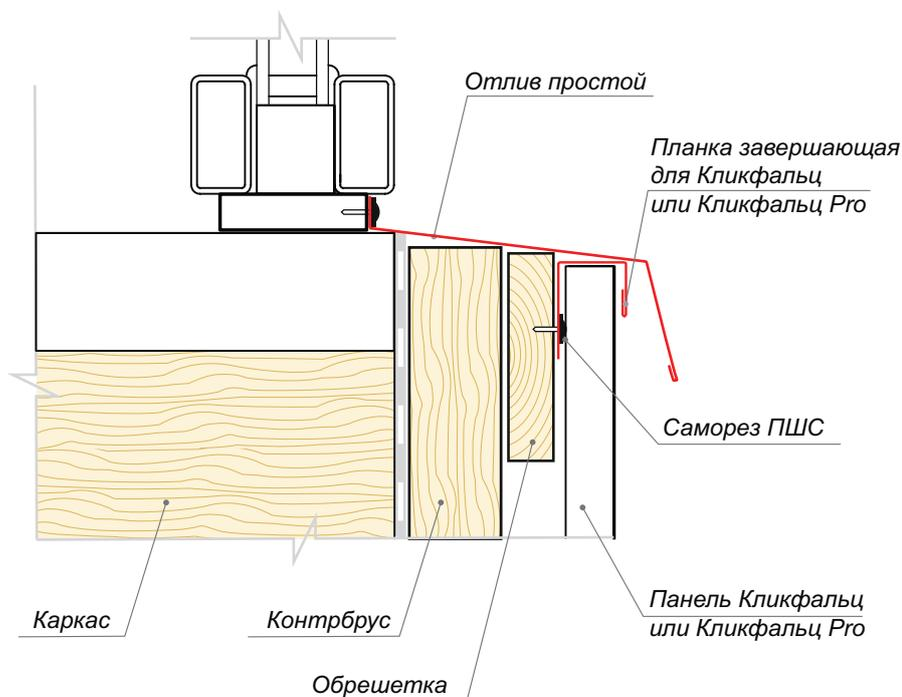
Установите финишную планку для фальц по нижней линии обрамления оконного проема. В приемный паз планки будет заходить верхний край панели.
