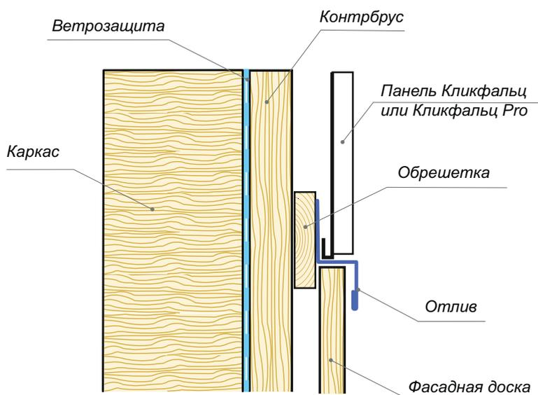
На горизонтальных переходах используйте отлив с рабочей полкой, соответствующей панелям:
