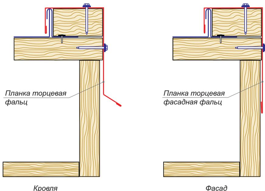
Используйте для отделки торца фасада Торцевую планку фасадную, для кровли – стандартную Торцевую планку для фальца.
