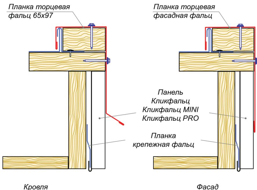
Установите крепежную планку по внутренней линии отделки торца. Сделайте разметку для монтажа панелей на торце.
