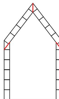
Крепление панелей между собой на углах производите одинарным фальцем (отмечено красными линиями). После отделки фронтона установите Планки торцевые фасадные, затем кровельные, как описано в инструкции по монтажу.
