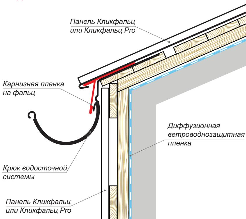
На карнизной части кровли сделайте сплошной настил из досок для установки длинных водосточных крюков и снегозадержателей. Крайнюю доску кровельной обрешетки выведете вперед, за пределы плоскости фасада на высоту замка панели. Кликфальц - 25 мм, Кликфальц PRO - 33 мм. Монтаж кровли удобнее вести после монтажа панелей на фасаде.
