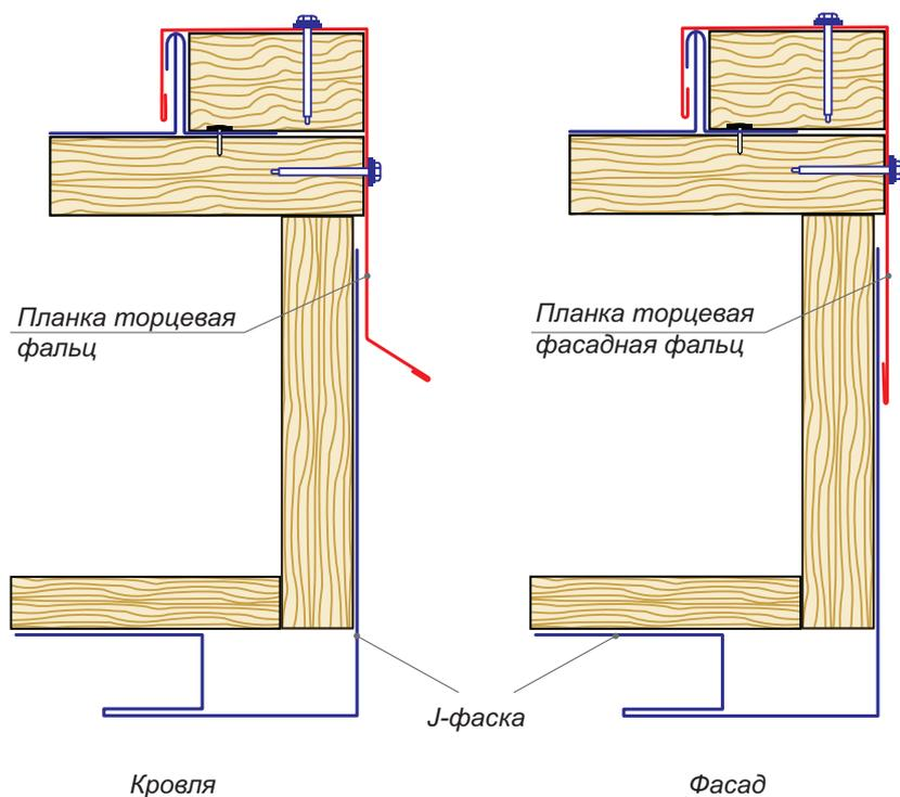
Для варианта отделки кровельного/фасадного свеса/выхода перед установкой Торцевых планок установите J-фаску необходимой длины или Лобовую планку.
