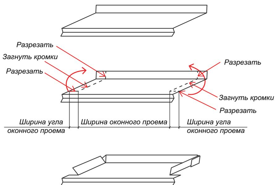
Выберете заранее размер рабочей полки Отлива простого. При выборе учтите, на сколько утоплена рама относительно обрешетки, а также высоту замка панели. Крепите отлив в подоконный профиль, допускается использовать монтажную пену.
