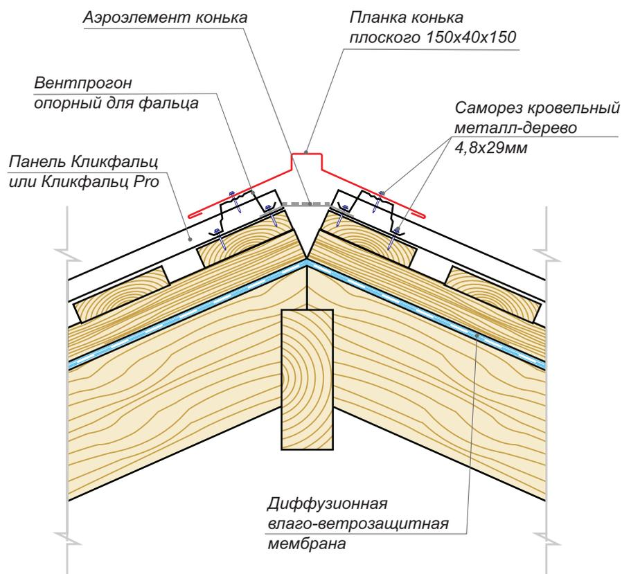
Для эффективной подкровельной вентиляции предусмотрите зазор между краями панелей противоположных скатов.
