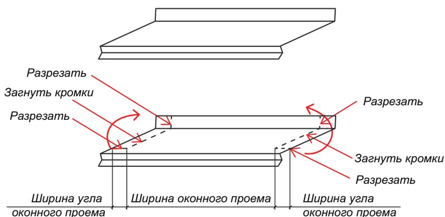
На нижней части оконного проема используйте Отлив простой. Перед монтажом Отлива простого выполните вырезы и загибы по схеме на рисунке.
