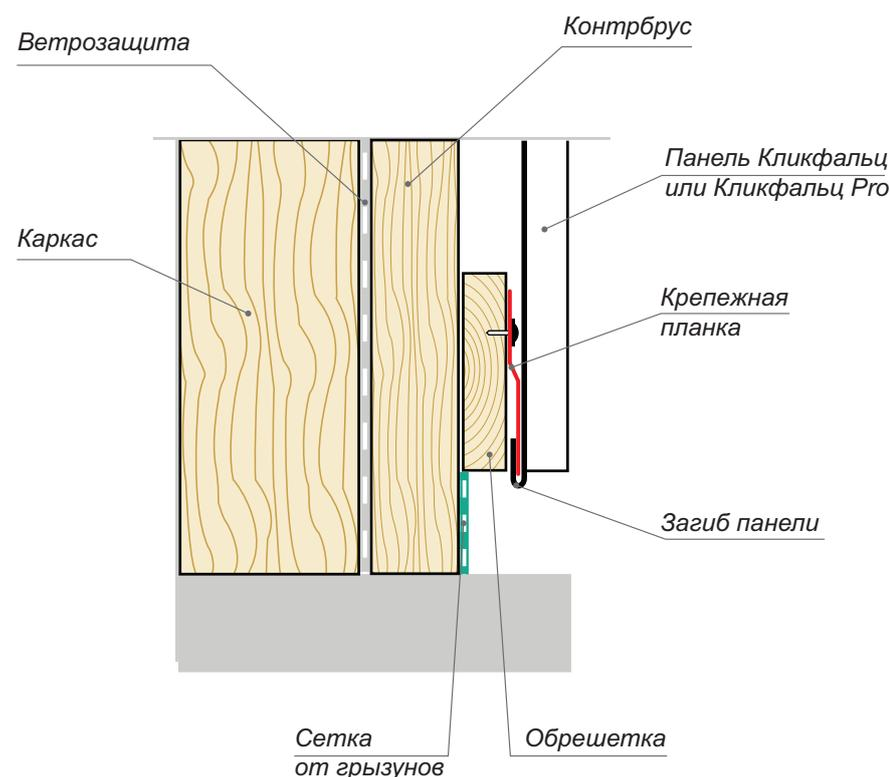
Установите сетку от грызунов так, чтобы она закрывала вход в вентиляционный канал.
