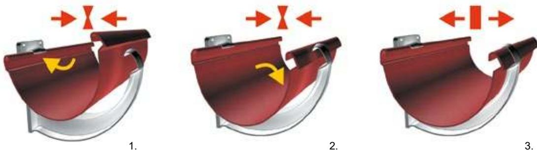
Для фиксации желоба в пластиковых кронштейнах или соединительных элементах заведите желоб в зажимы со стороны карниза (1) и, слегка надавливая на переднее ребро желоба в сторону карниза, опустите его в кронштейн или соединительный элемент.
